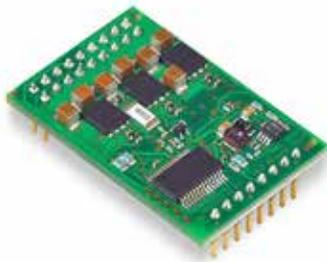
El DEC Module 50/5 (Digital EC Controller) es un amplificador 1-Q-EC para el control de motores brushless con sensores Hall y una potencia máxima de salida de 250 W.
