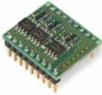
El DEC 24/2 (Digital EC Controller) es un amplificador de 1 cuadrante para el control de motores brushless con sensores Hall. Potencia máxima de salida 48 W.
