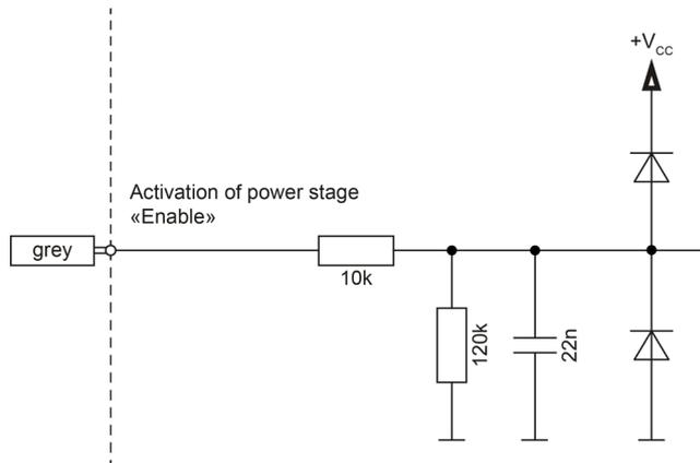
Figure 11 «Enable» – Input circuitry
