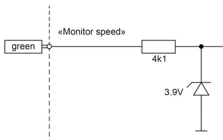
Figure 13 «Monitor speed» – Output circuitry
