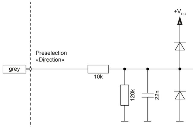
Figure 12 «Direction» – Input circuitry
